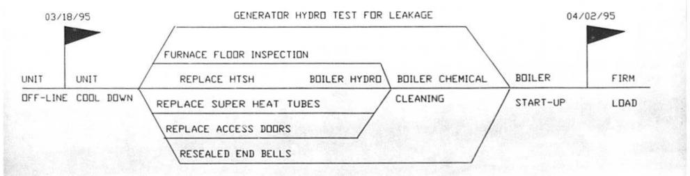
TAMPA ELECTRIC COMPANY BIG BEND UNIT NO. 1 PLANNED DUTAGE 1995 ACTUAL CPM 04/30/95
