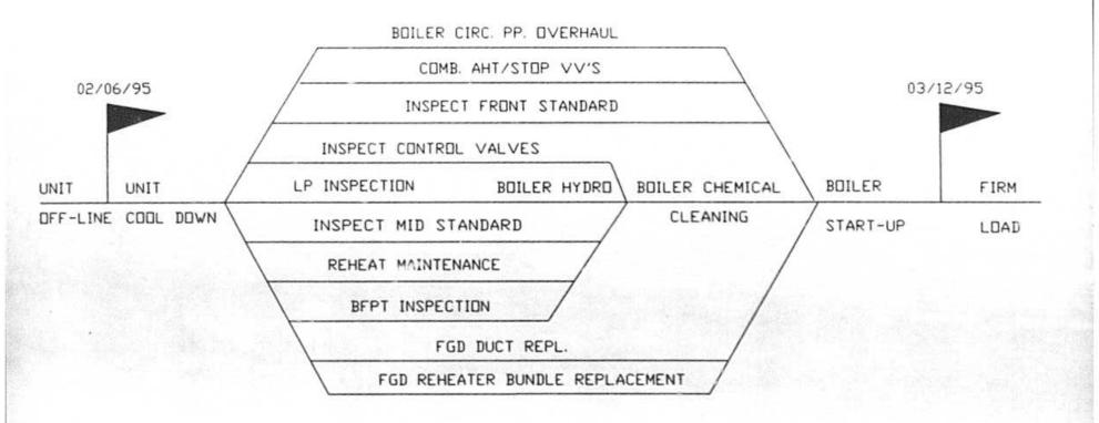
TAMPA ELECTRIC COMPANY BIG BEND UNIT NO. 4 PLANNED DUTAGE 1995 ACTUAL CPM 03/31/95
