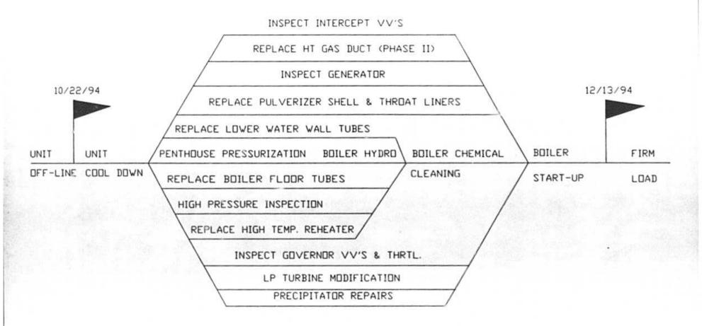
TAMPA ELECTRIC COMPANY BIG BEND UNIT NO. 2 PLANNED DUTAGE 1994 ACTUAL CPM 12/31/94
