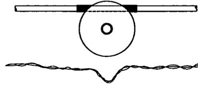
STEP 2: POSITION THE TIE LOOP UNDER THE INSULATOR SO THE LEGS ARE PARALLEL TO THE CONDUCTOR AS SHOWN.
