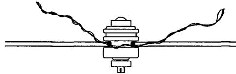
STEP 2: POSITION THE TIE LOOP TIGHTLY AGAINST THE INSULATOR'S GROOVE, ON THE OPPOSITE SIDE FROM THE CONDUCTOR, AS SHOWN.
