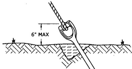
ANCHOR EYE ORIENTATION IS LEFT TO THE DISCRETION OF THE INSTALLER
