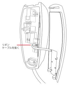
注意:フロント カバーを外す際にリボン ケーブルを傷つけないようにしてください。フロント カバーを完全に取り外す前にリボンケーブルを抜きます。
